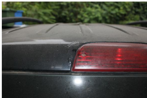
korrozó a tetőlemezen
