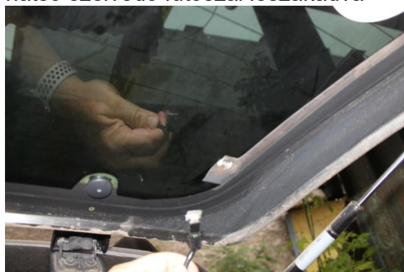
hátsó szélvédő fűtőszál leszakadva
